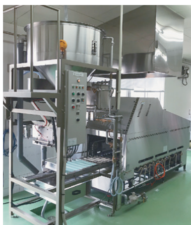
幼稚園・小学校・中学校給食の炊飯設備
